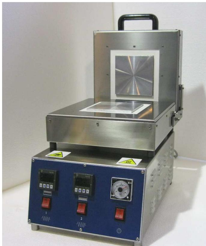
Apparecchiatura per il controllo della resistenza dei colori nei tessuti, allo stiro a caldo, alla sublimazione, al calore secco.
