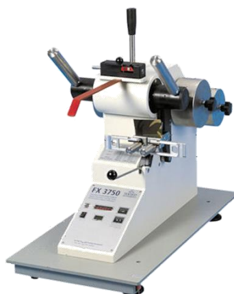
FX 3750 ElmenDorf Elmendorf Tearing Tester
